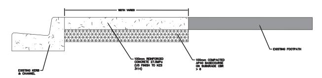
CONCRETE PAD TYPICAL DETAIL
